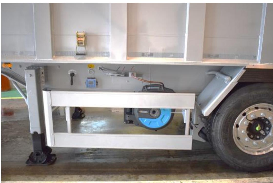
Le lavage embarqué est équipé d'un réservoir d'eau 120L protégé contre le gel, d'un dévidoir avec pistolet (enrouleur du tuyau) de 25m ainsi que de 3 vannes de contrôle.
