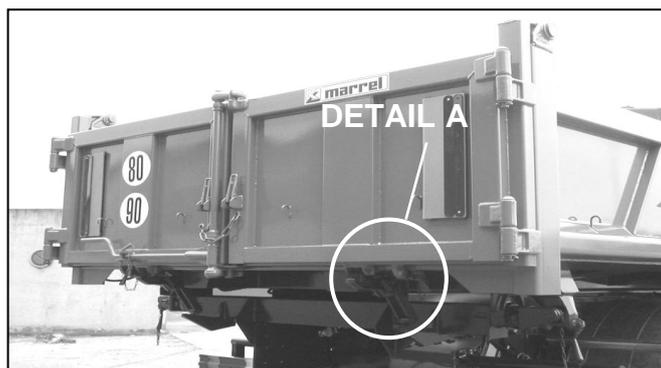
Porte arrière correctement verrouillée (les crochets de verrouillage doivent être correctement engagés).
