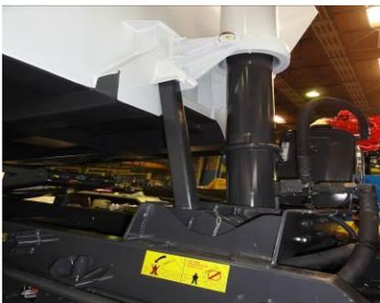
Pour toutes les opérations nécessitant de travailler sous la caisse, il est **impératif** d'utiliser le **système de calage** prévu à cet effet
