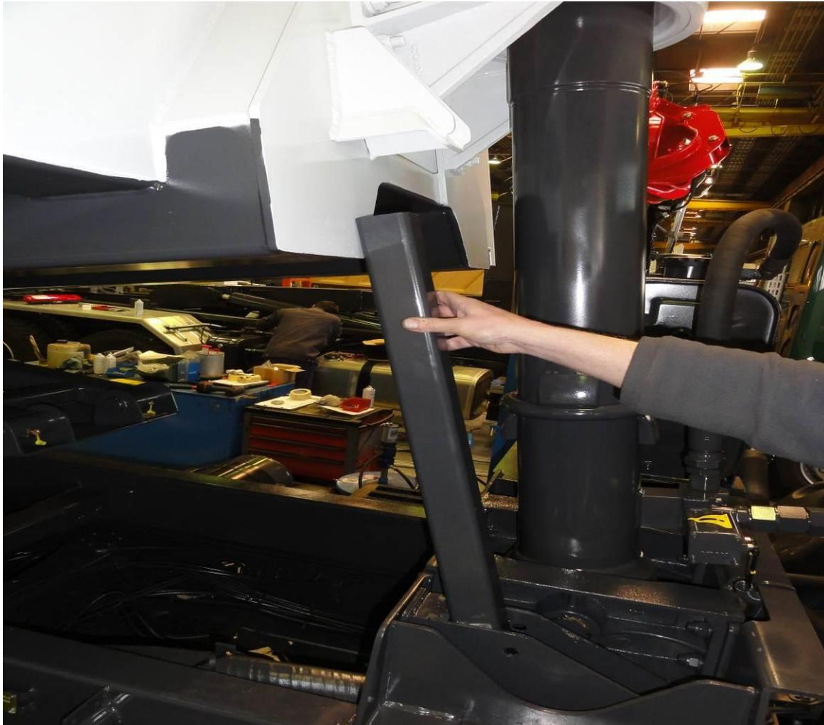
Votre équipement comporte un système incorporé de calage benne à vide (système de **sécurité** permettant de prévenir tout risque de **chute intempestive de benne** et d'accident).
