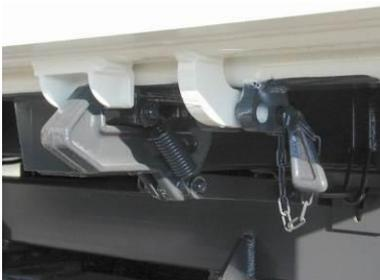
La porte arrière est correctement verrouillée lorsque les crochets de verrouillage sont engagés dans les axes.
