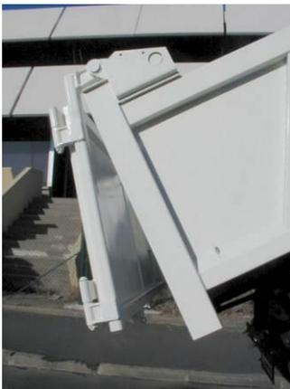
La porte arrière comporte **une articulation haute** qui se déverrouille automatiquement en partie basse à un angle de basculement de benne d'environ 15°.
