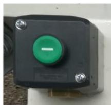
Relevage en charge du premier essieu, en appuyant sur le bouton ci-dessus, situé sur la platine de commande côté gauche de la Pulltrack.
