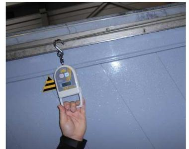
**Seilspannung prüfen:** Das Schieberverdeck ist komplett zu öffnen und wieder ca. 50 cm zu schließen. Es ist in der Mitte des oberen Spannseiles ein Gewicht o.ä. mit einer Masse zw. 8 und 9 kg ca. einzuhängen, bis das obere Seil parallel zu dem unteren kommt.
