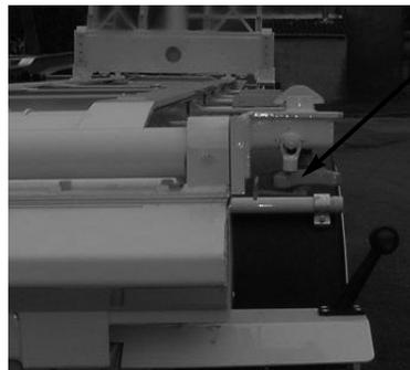
El volante de apriete del TWIST LOCK en posición cerrada debe estar apretado a fondo
