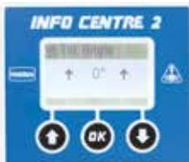
Affiche l'angle d'inclinaison de la remorque en degré tel que relevé par l'EB+
