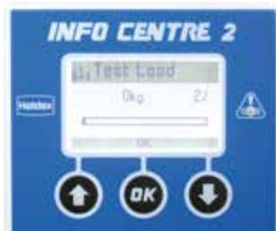
La précision de la charge affichée dépend de la configuration correcte des informations pendant la programmation de l'UCE en utilisant DIAG+.
