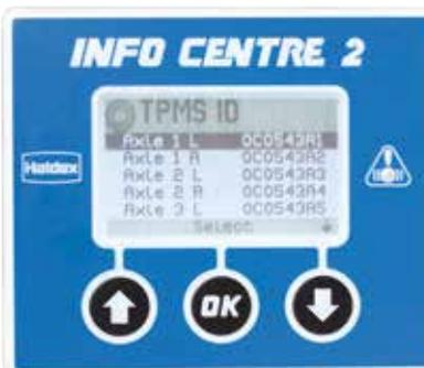
Utiliser le bouton
