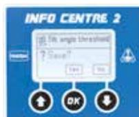
Permet de définir l'angle de gîte pour le déclenchement du clignotement de la LED de service.
