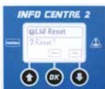
Utiliser le bouton
