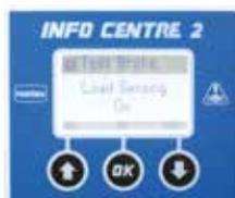
Utiliser la flèche
