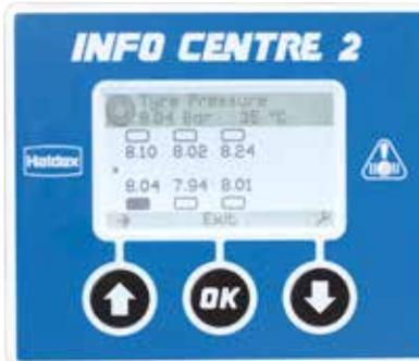
Utiliser le bouton
