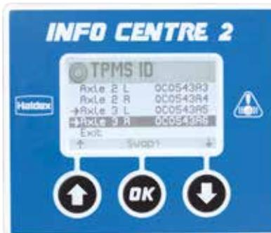
Utiliser le bouton
