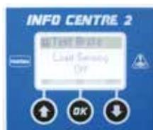
Utiliser la flèche
