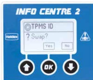
Utiliser le bouton
