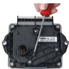
Retirer les vis à l'aide d'un tournevis Torx T20.
