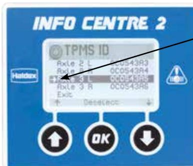
Une flèche indique que le capteur a été sélectionné.
