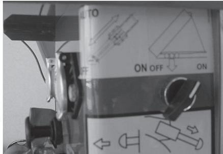
Ein Schalter auf dem Unterstruktur des Kupplungskopfes neutralisiert die Funktion (Beispiel: Verwendung eines Fertigers, Abb. 35-2).
