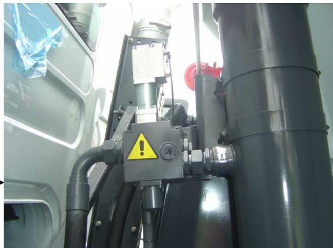
Votre équipement est muni d'un clapet anti-retour de sécurité qui prévient tout risque de chute intempestive de benne et d'accident (**risque d'écrasement**) en cas de rupture du flexible d'alimentation.
