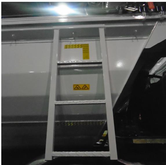
Cette échelle permet de vérifier votre chargement en toute sécurité et il est formellement interdit de s'en servir afin de monter à l'intérieur de la benne.
