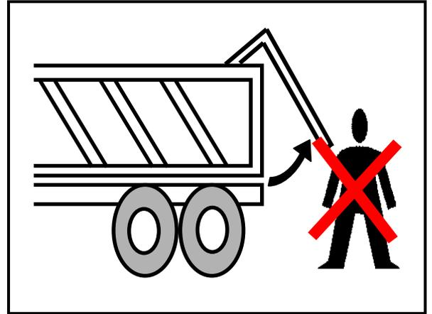
L'ouverture de la porte arrière hydraulique est **instantanée** (risque d'accident mortel).
