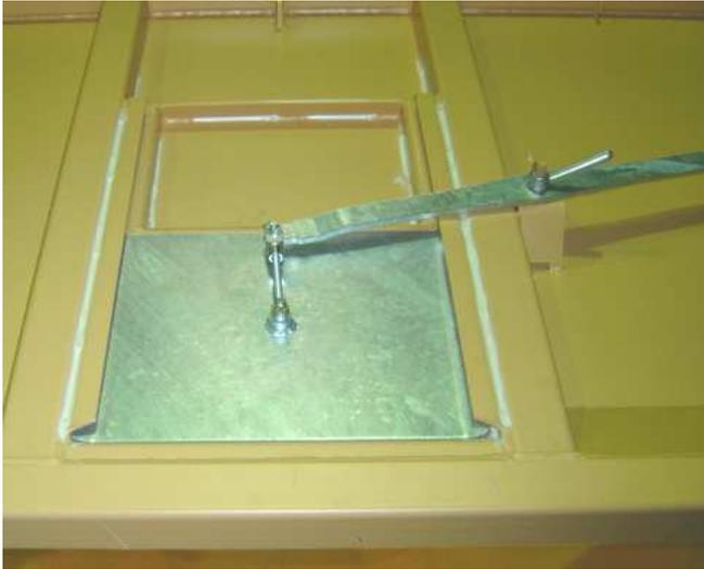
Pour manipuler cette trappe il faut que la benne soit en position basse et que la prise de mouvement soit désenclenchée.
