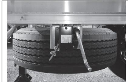
Um an das Reserverad zu gelangen, die Unterfahrschutzvorrichtungen, falls nötig, mittels des Radmutter Schlüssels demontieren.
