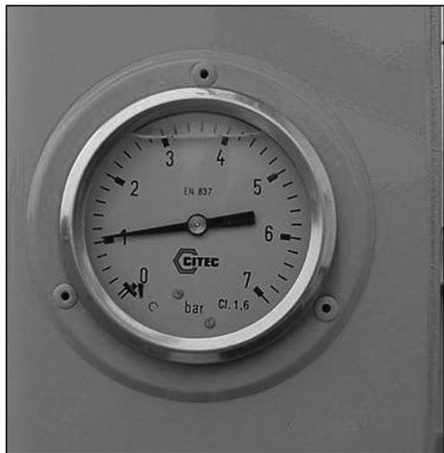
Diese optionale Ausrüstung ermöglicht es Ihnen, das ungefähre Gewicht unter dem Achsaggregat zu bestimmen (Abb. 48-1).
