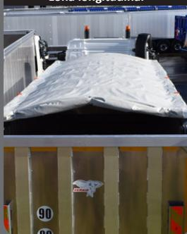
Lona longitudinal por cabo com comando manual ou elétrico
