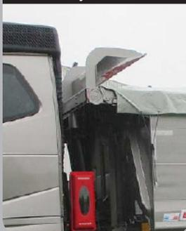
Estrutura em alumínio para a proteção da lona adaptada para a construção e obras públicas
