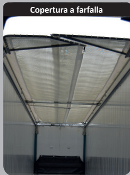
Copertura a farfalla
