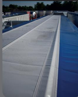
Telo di copertura ad apertura laterale con cinghie fissaggio telo, compatibile con ogni tipo di porta posteriore.
