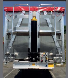
Parete anteriore verticale con cilindro esterno, per fornire una volumetria fino a 80m<sup>3</sup>
