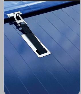
Passaggio delle cinghie laterali all'interno delle pareti laterali della cassa
