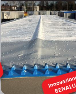
Sistema di copertura elettrica EASYTARP completamente automatico con controllo tramite radiocomando
