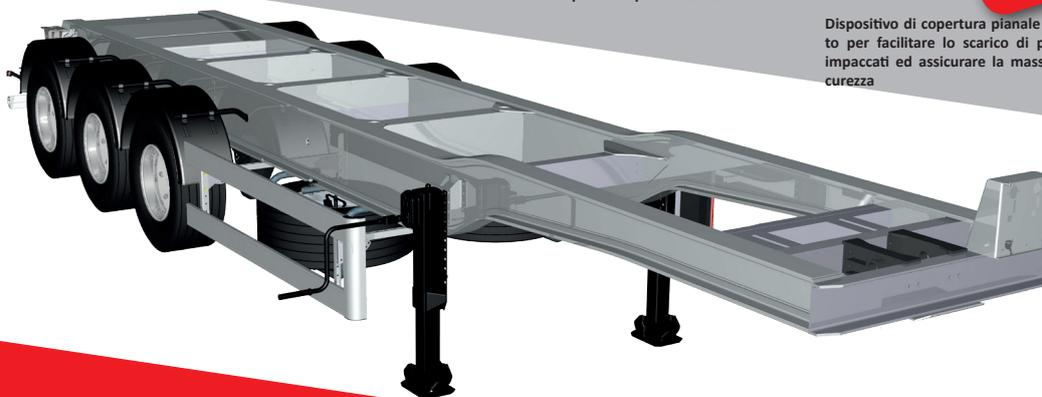
**Telaio a collo d'oca 100% in alluminio per garantire la stabilità**
