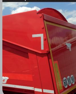
Porta posteriore idraulica a singolo o doppio effetto con un ampio angolo di apertura.
