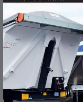
Cilindro frontale incassato e saldamente imbullonato per garantire robustezza per lavori in edilizia e lavori stradali.
