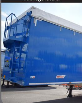
Bâchage latéral manuel ou électrique (EASY TARP) avec passerelle d'accès sur face avant.
