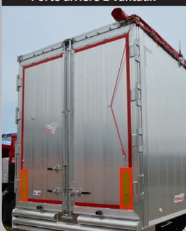
Porte double vantaux semi-encastée (2 crémones). Soudures en continu et butoir transversal continu sur caisson pour la mise à quai
