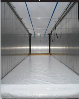
Bâche de protection de fond (avec enrouleur pneumatique ou manuel) pour le transport de conditionnements fragiles, abrasifs, ou très fins.
