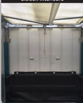
Cloison intérieure mobile renforcée (ép. 6mm) avec bâche renforcement
