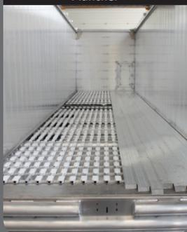
Plancher lisse ou strié en épaisseur en 6,8 ou 10mm. Avec guidage sur ossature tubulaire et patins Teflon
