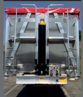
Une face avant droite avec verin à cloche extérieur qui offre un volume allant jusqu'à 89m³!
