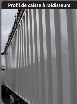
Profil de caisse à raidisseurs
