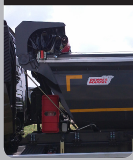
Système de bâchage longitudinal
