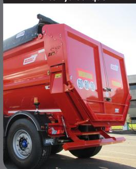
Porte hydraulique double effet relevable par un double vérin
