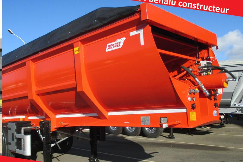
Type : Benne à déchargement horizontale
