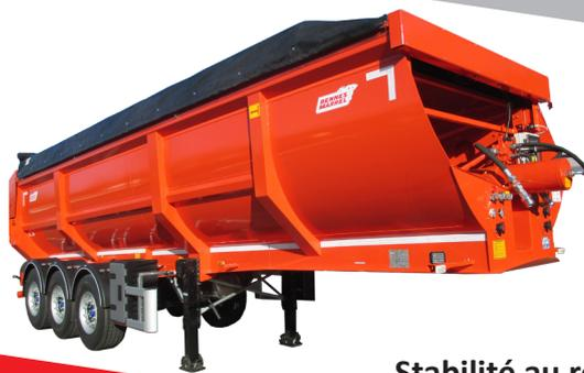
Stabilité au roulage grâce au centre de gravité bas !
