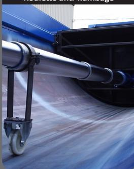
Béquille anti-flambage qui assure une sécurité maximale lors du déploiement du vérin
