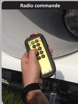
Radio commande (option) qui permet d'activer les différentes fonctions de la benne (bâchage, éjection, BAE, porte, ...)
