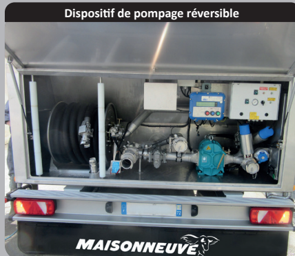
Dispositif de pompage réversible
