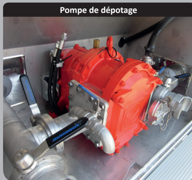
Pompe de dépotage
